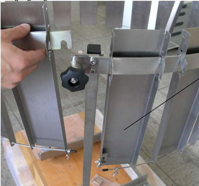
Windschutzblech mit Schnellverschlussystem für das Edelstahl-Seil, montiert rechts neben dem Zugangssegment.
