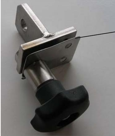
Segment-Halterung für das Zugangssegment mit Sterngriff-Mutter
