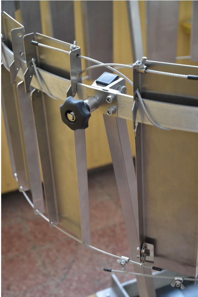
Ansicht des fertig installierten Spanndrahtes (unten) sowie des LaBS (oben)
