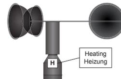
Die Heizung verhindert unter den meisten klimatischen Bedingungen das Blockieren der beweglichen Teile (siehe Abb.). Der Schalenstern bzw. die Windfahne werden nicht beheizt. Bei möglicher Vereisung oder Eisbildung am beweglichen Sensorelement ist die Funktion für die Dauer der Vereisung eingeschränkt.
