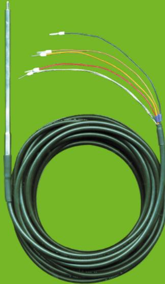
Der Sensor (8281) ermittelt die Lufttemperatur mit einem Platin-Widerstandsmesselement Pt100. Die Schutzhütte (8141.6) schützt den Sensor vor ungewollten Witterungseinflüssen wie Niederschlag und Strahlung und dient zur Schaffung optimaler Messbedingungen.
