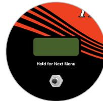
Wird der ON Druckknopf für 2 Sekunden gedrückt und dann wieder losgelassen springt das Menü zur nächsten Menüanzeige und bei wiederholtem Drücken und Halten für 2 Sekunden schrittweise weiter bis zu den verschiedenen Menüpunkten.
