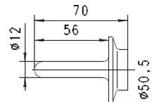
Fühler für Tri-Clamp-Anschluss
