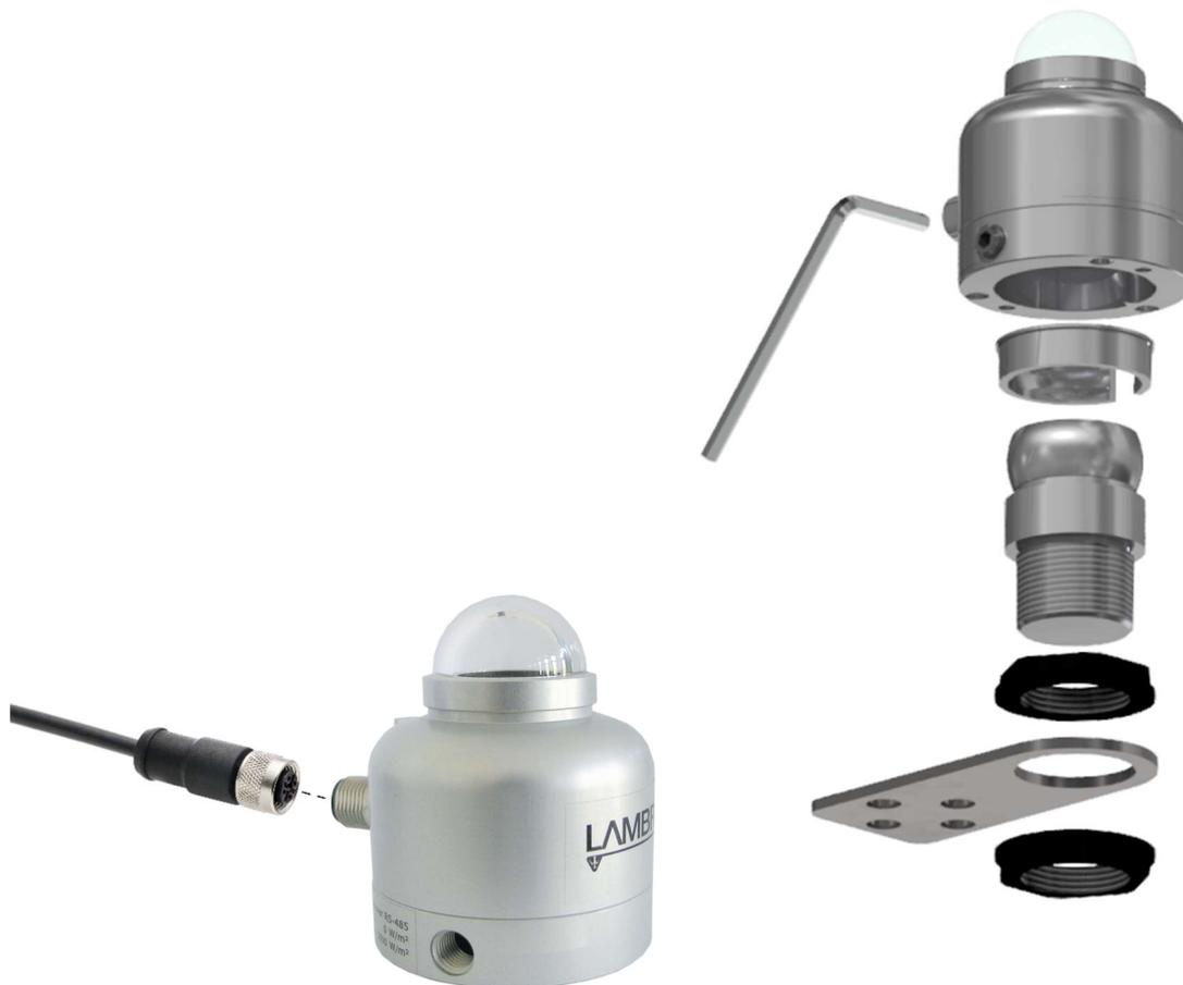
**Abbildung 4.2.1** Von links nach rechts: 16103.5 in der Standardkonfiguration; mit optionaler Kugelnivellierung zur einfachen Montage und Nivellierung auf einer (nicht-)horizontalen Fläche; mit optionaler Kugelnivellierung und Rohrhalterung zur einfachen Montage auf einem Rohr mit 25 bis 40 mm Durchmesser. Befestigungsschrauben sind im Lieferumfang der Kugelausgleichs- und / oder Rohrhalterung enthalten.
