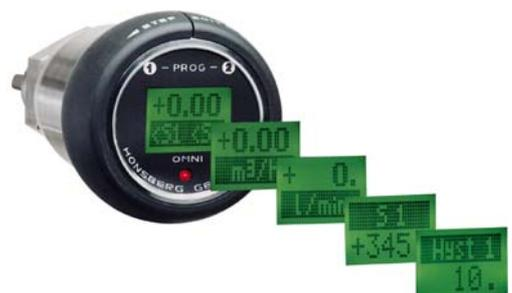
Über einen Code können weitere **Parameter verändert** werden: Signalfilter, wählbare Einheit [bar, psi ...] inkl. automatischer Umrechnung der Werte, wählbarer Ausgang 0 oder 4...20mA, Wertezuordnung von 4(0) und 20mA (Einstellung von Nullpunkt und Spanne).
