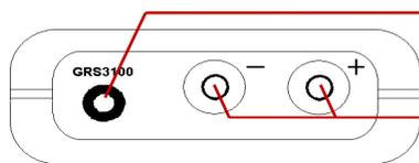
**Ausgang:** Anschluss für Schnittstellen-Konverter bzw. für den Analogausgang (siehe Kapitel 9)
