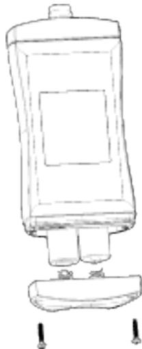
**Abb. 10: Batteriewechsel**
