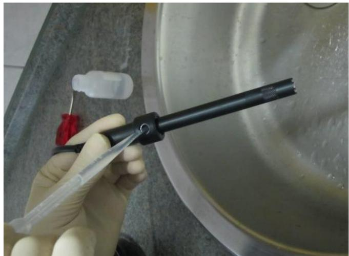
*Abbildung: Befüllung mit Pipette*
