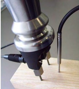
Hohlhammerlektrode GHE91 mit Temperaturfühler GTF38
