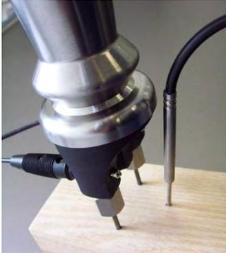
Hohlhammerlektrode GHE91 mit Temperaturfühler GTF38
