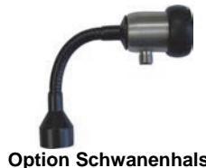
Ein Schwanenhals (Option) zwischen Elektronikkopf und Primärsensor bringt Freiheit in der Ausrichtung des Sensors. Gleichzeitig sorgt diese Option für eine thermische Entkopplung zwischen beiden Einheiten
