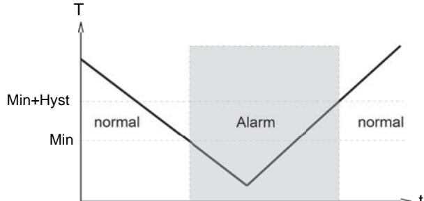
Bei einem Maximum-Schalter führt das Überschreiten des Grenzwertes zum Umschalten in den Alarmzustand. Die Rückkehr in den Normalzustand erfolgt, wenn der Grenzwert abzüglich der eingesetzten Hysterese wieder unterschritten wird.
