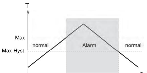
Das Wechseln in den Alarmzustand wird durch die integrierte rote LED und eine Klarschriftmeldung im Display angezeigt.
