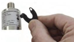
Der Clip kann nach dem Programmieren ("Teachen") entweder am Gerät belassen oder zur Datensicherheit entfernt werden. Das Gerät besitzt eine gelbe LED, die während des Programmierpulses blinkt. Im Betrieb dient die LED als Zustandsanzeige des Schaltausganges.
