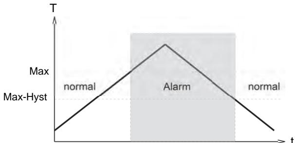
Das Wechseln in den Alarmzustand kann mit einer Schaltverzögerungszeit ( $t_{DS}$ ) versehen werden. Ebenso kann das Rückschalten in den Normalzustand mit einer davon verschiedenen Rückschaltverzögerungszeit ( $t_{DR}$ ) versehen werden.
