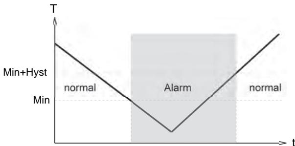
Bei einem Maximum-Schalter führt das Überschreiten des Grenzwertes zum Umschalten in den Alarmzustand. Die Rückkehr in den Normalzustand erfolgt, wenn der Grenzwert abzüglich der eingesetzten Hysterese wieder unterschritten wird.
