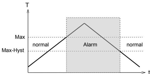
Das Wechseln in den Alarmzustand wird durch die integrierte rote LED und eine Klarschriftmeldung im Display angezeigt. Die Schaltausgänge sind im Normalzustand auf Versorgungsspannungspegel, im Alarmzustand auf 0 V, so dass ein Kabelbruch beim Signalempfänger ebenfalls Alarmzustand anzeigt würde.
