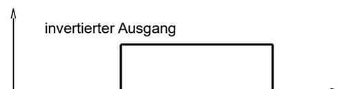
Eine optional bestellbare Power-On-Delay-Funktion ermöglicht es, den Schaltausgang nach dem Anlegen der Versorgungsspannung für eine definierte Zeit im Normalzustand zu halten.
