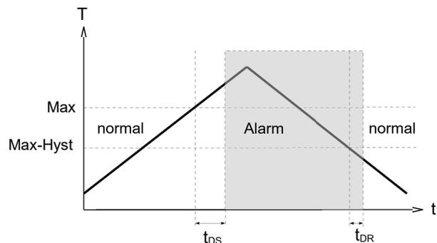
(Im Normalzustand ist die integrierte LED an, im Alarmzustand aus, was dem Zustand bei fehlender Versorgungsspannung entspricht.)
