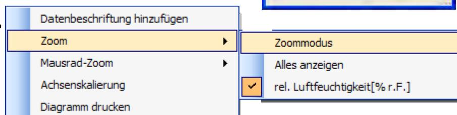
das Untermenü 'Zoom' öffnen und die gewünschten Kurven auswählen welche gezoomt werden sollen und einen Haken bei 'Zoommodus' setzen. Nun ändert sich der Cursor in ein Kreuz. Man kann jetzt einen Rahmen um den gewünschten Bereich im Diagramm ziehen. und dieser wird dann vergrößert angezeigt.
