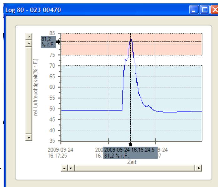
Min.- und Max.-Alarmgrenze wird durch einen blauen bzw. roten Bereich dargestellt. Befindet sich die Messkurve im blauen Bereich so wurde während dieser Zeit die Min.-Alarmgrenze unterschritten.
