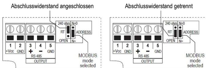
Der Leitungsschirm muss mit beiden Leitungsenden verbunden werden. Das Kabel sollte folgende Eigenschaften aufweisen:
