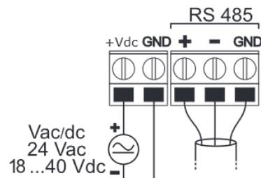
Dank des RS485-Ausgangs können mehrere Geräte angeschlossen werden und so ein Netzwerk bilden, verbunden als Bus über ein geschirmtes Kabel mit einem verdrilltem Leitungspaar für das Signal und einem dritten Draht für den Nullleiter.
