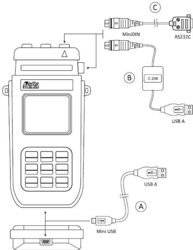
**A** Die portablen Datenlogger der Serie HD21...2 wurden mit einem seriellen Mini USB-Port vom Typ HID (Human Interface Device) versehen. Für den Anschluss an einen PC über das Kabel USB Typ A – Mini USB Typ B Code CP23 ist die Installation eines USB-Treibers nicht nötig.
