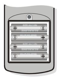
Nach dem Batteriewechsel werden das Datum, die Uhrzeit, die Baudrate, der Sondentyp, das Druckintervall, die Logging-Parameter wieder eingestellt: zur Vereinfachung schaltet sich das Gerät bei Einlegen der neuen Batterien automatisch ein und fordert der Reihe nach alle
