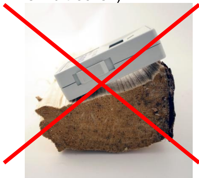
Falsch: Verworfene Oberfläche (hier extrem!)
