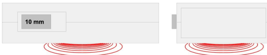
Seitenansicht: Messfeld und Eindringtiefe bei Schalterstellung „10 mm“
