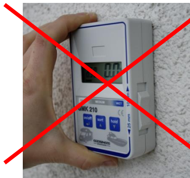
Falsch: unregelmäßige Oberfläche
