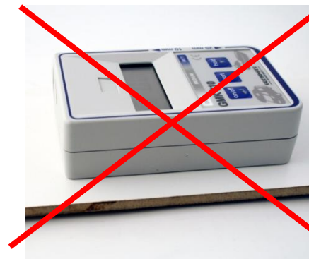
Falsch: zu geringe Materialstärke
