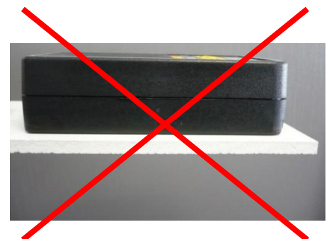
Falsch: zu geringe Materialstärke
