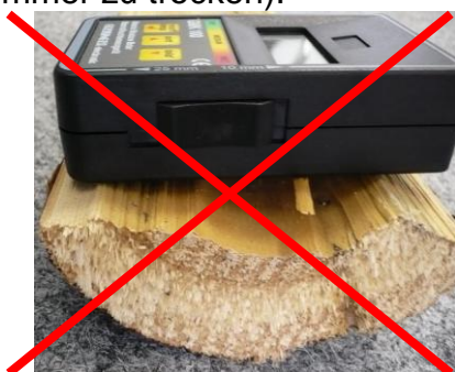
Falsch: Verworfene Oberfläche (hier extrem!)
