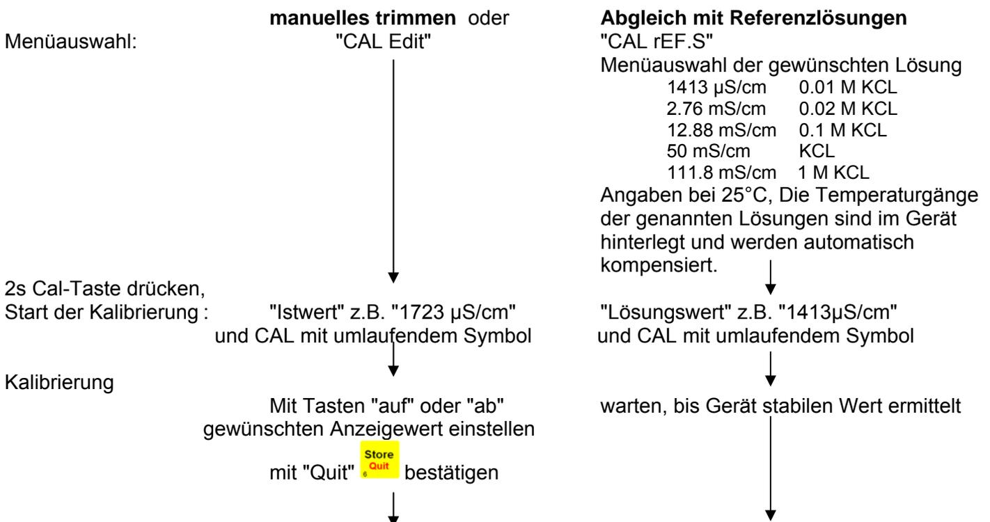
danach kehrt das Gerät in den normalen Messbetrieb zurück, oder bringt ggfs. eine Fehlermeldung Die resultierende Zell-Korrektur ist im Menü unter „CELL Corr“ einsehbar.
