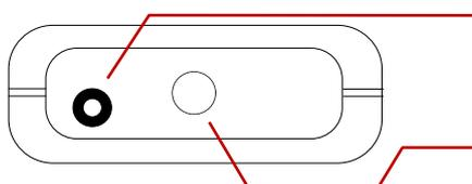
**Schnittstelle:** Zum Anschluss über einen Schnittstellenadapter (z.B. USB 3100 N)
