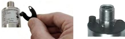
Der Clip kann nach dem Programmieren („Teachen“) entweder am Gerät belassen oder zur Datensicherheit entfernt werden. Das Gerät besitzt eine gelbe LED, die während des Programmierpulses blinkt. Im Betrieb dient die LED als Zustandsanzeige des Schaltausganges.
