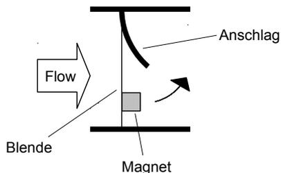
Auf der Blende befindet sich ein kunststoffgekapselter Magnet. Bei Auslenkung ändert sich sein Magnetfeld, das von einem Sensor außerhalb des Strömungsraumes detektiert wird.
