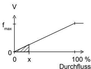
$f_{max}$  wählbar im Bereich bis zu 2000 Hz
