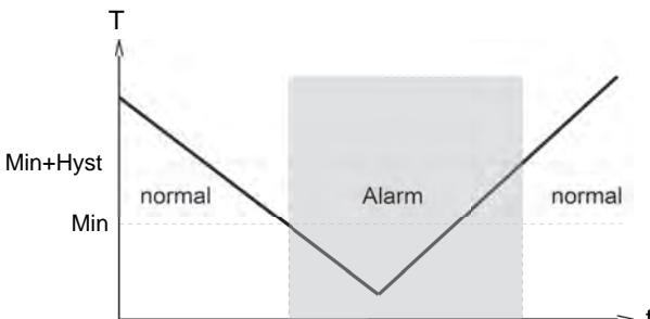
Bei einem Maximum-Schalter führt das Überschreiten des Grenzwertes zum Umschalten in den Alarmzustand. Die Rückkehr in den Normalzustand erfolgt, wenn der Grenzwert abzüglich der eingestellten Hysterese wieder unterschritten wird.
