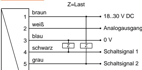
Vor der Elektroinstallation ist darauf zu achten, dass die Versorgungsspannung den Datenangaben entspricht!
