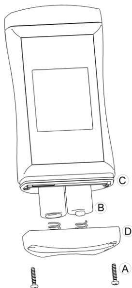
Abb. 6: Batteriewechsel
