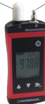
Die G1111-xx-VAC besitzen neben dem Druckanschluss noch einen Druckausgleich. Somit kann sich beim Evakuieren kein gefährlicher Gehäuseinnendruck aufbauen und auf der anderen Seite können beim Entspannen des Vakuums keine Partikel in das Geräteinnere gelangen, da das Druckausgleichselement als extrem feiner Porenfilter wirkt.
